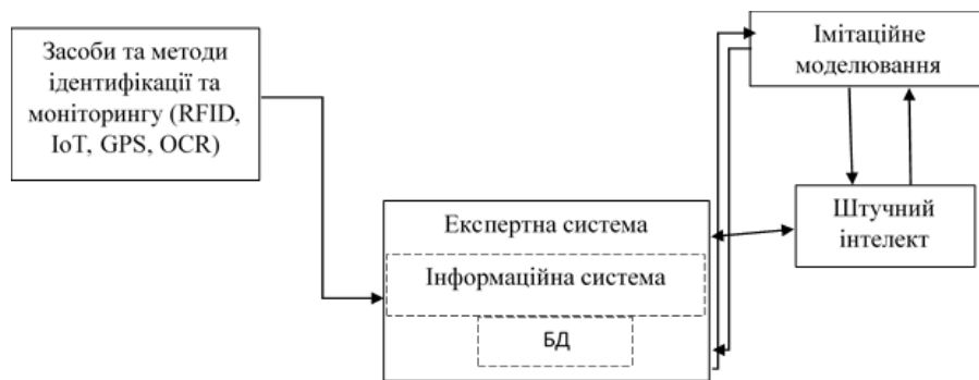
Рисунок 1 - Загальна функціональна схема цифрової трансформації контейнерного терміналу
