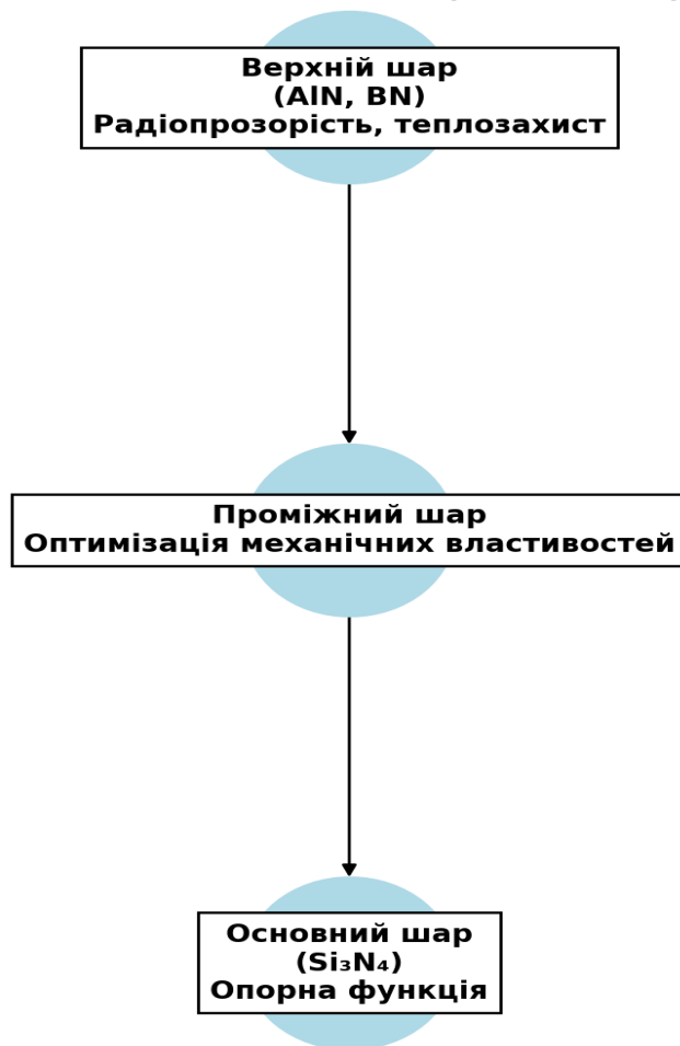
Рисунок 1 - умовна схема багатошарового покриття
