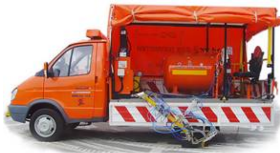
Рисунок 13.5 – Машина для нанесення дорожньої розмітки змонтована на шасі автомобіля
