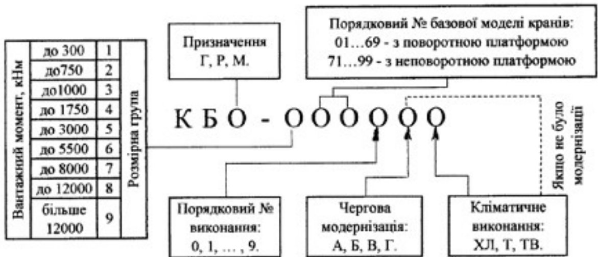
Рисунок 6.1– Система індексації баштових кранів
