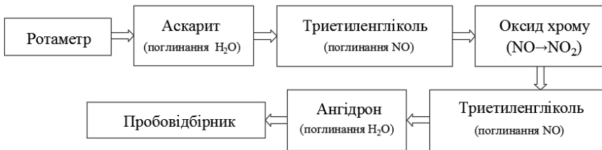
Рис. 4.5. Схема підготовки та відбору проб
