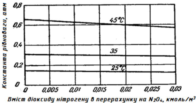
Рис. 1.16. Залежність константи рівноваги реакції полімеризації \text{NO}_2 від його концентрації при різних температурах
