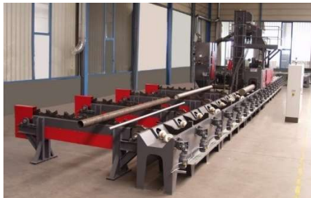
Рис. 79. Сучасний вібраційний верстат для обробки довгомірних деталей фірми Rosler
