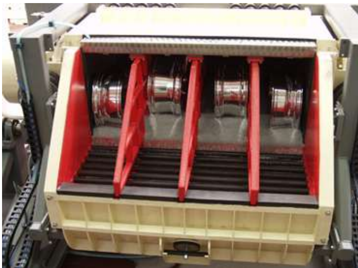
Рис. 28. Обробка деталей у відсіках контейнера
