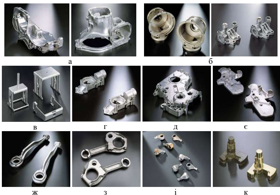
Рис. 29. Деякі деталі, що піддають вібраційній обробці: а – картери коробок передач; б – корпуси насосів; в – корпуси друкарських машин; г – корпуси електродвигунів; д – кришки коробок передач; е – кришки розподільних коробок; ж – кулі; з – шатуни; і – коромисла; к – запірні важелі
