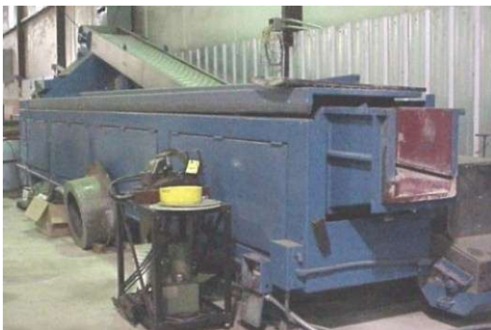
Рис. 32. Приклад перших вібраційних верстатів конвеєрного типу
