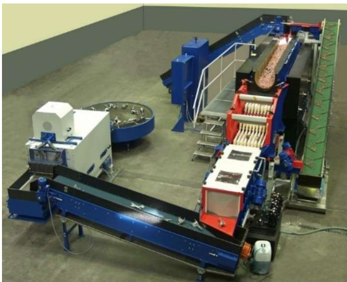
Рис. 33. Сучасний вібраційний верстат конвеєрного типу з U-подібним контейнером фірми Rosler
