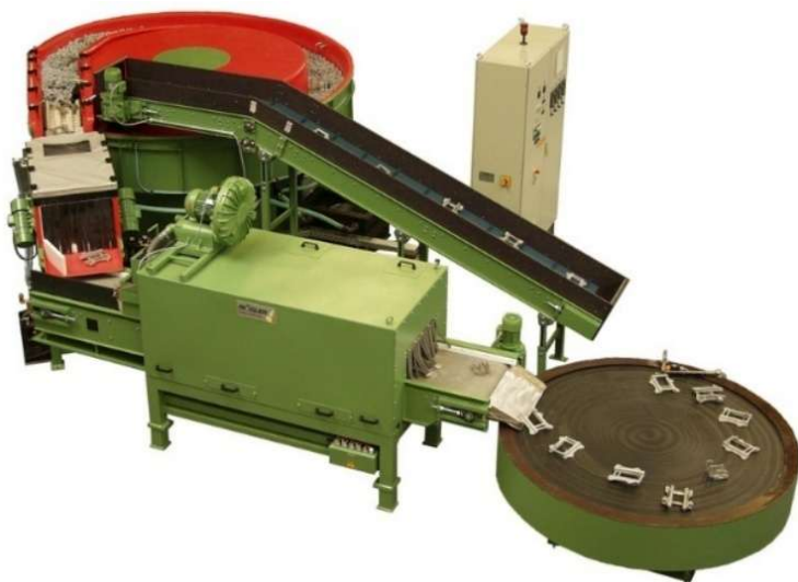
Рис. 34. Вібраційний верстат конвеєрного типу з тороїдальним контейнером фірми Rosler
