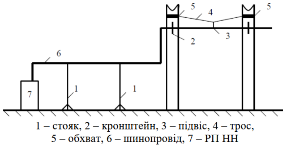
Рисунок 3.8 – Прокладка магістрального шинопроводу
