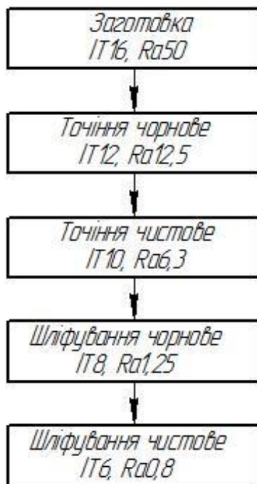
Рисунок 3.16 – Етапи та види обробки поверхні Ø25js6
