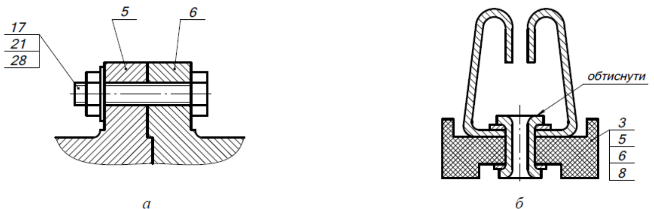
Рисунок 1.2 – Приклад нанесення номерів позицій деталей на складальному кресленнику
