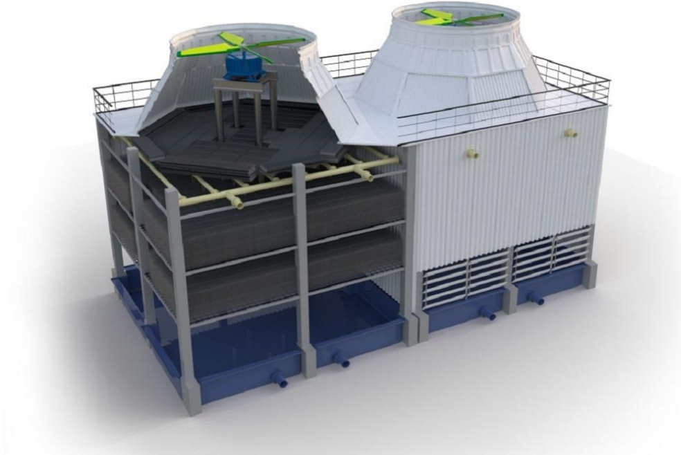
Рисунок 4.4 — Схема вентиляторної градирні
