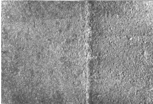
Рис. 16. Корозія по ватерлінії в контейнері рідкого хлору, \times 2
