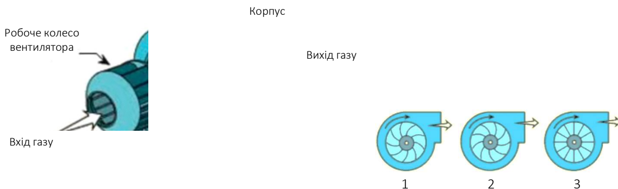
Рис. 30. Відцентровий вентилятор та робоче колесо вентилятора: 1 – вигнуте вперед; 2 – вигнуте назад; 3 – радіальне.
