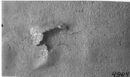
Рис. 17. Водне розтріскування труби магістрального газопровіду (а), розтріскування днища вуглекислотного балону системи пожежотушіння газоперекачуючої станції (б), \times 2
