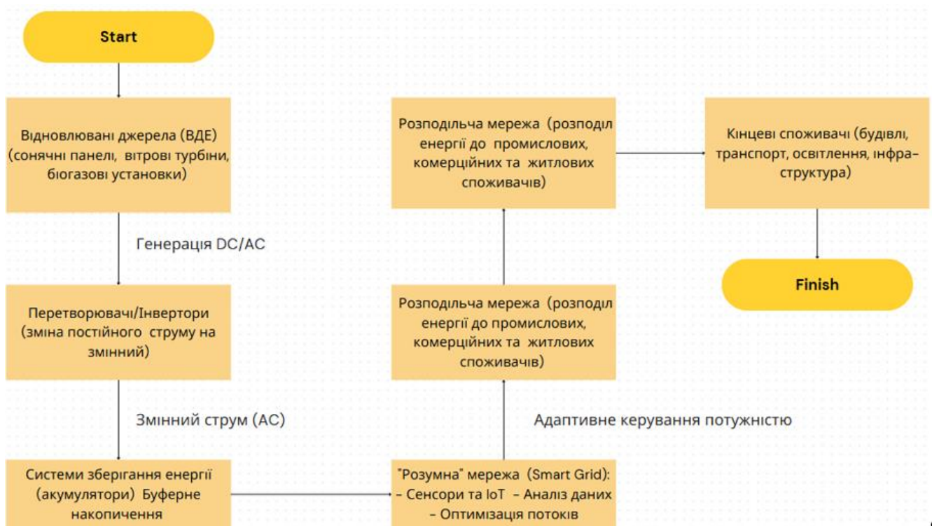
Рисунок 1 - Приклад наочної технічної блок-схеми інтеграції ВДЕ
