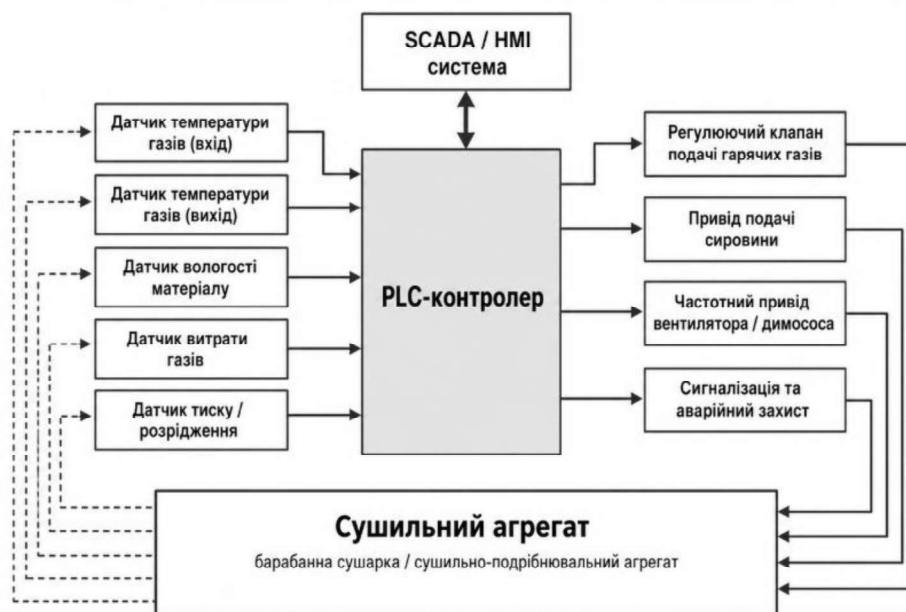
Рисунок — Структурна схема комп'ютерно-інтегрованої системи автоматизації процесу сушіння у виробництві цементу.
