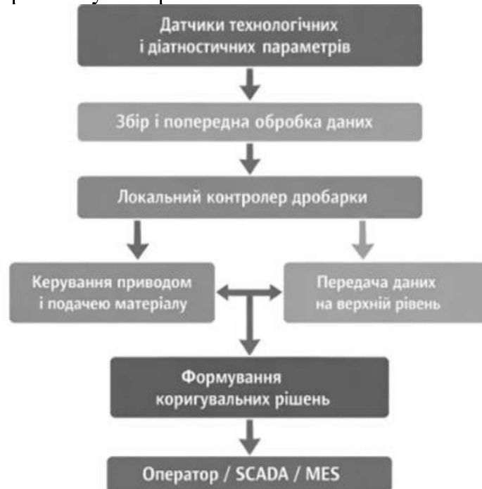
Рисунок – Узагальнена структура комп'ютерно-інтегрованої системи керування дробаркою
