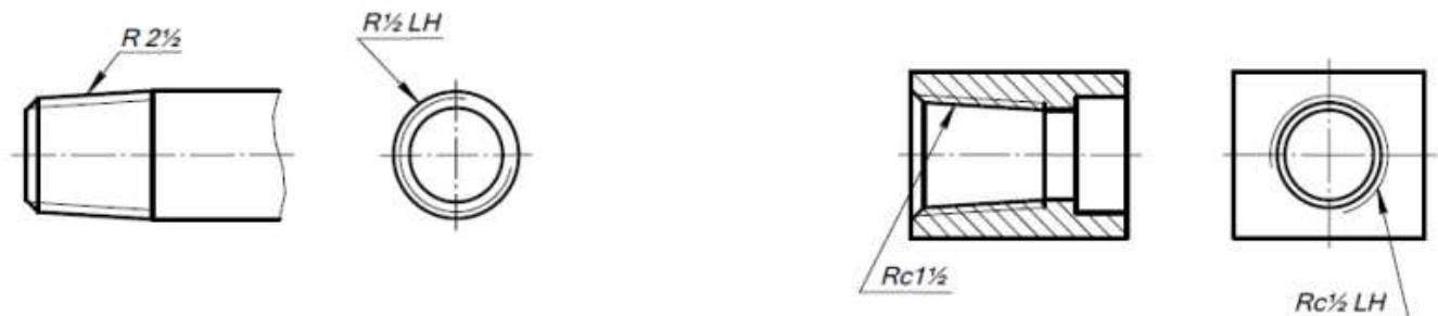
Рисунок 8.12 - Трубна конічна різь
