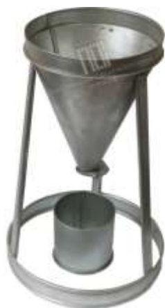
Рис. 3. Воронка ЛОВ: 1 – воронка; 2 – калібрований патрубок; 3 – заслінка; 4 – мірний циліндр об'ємом 1 літр
