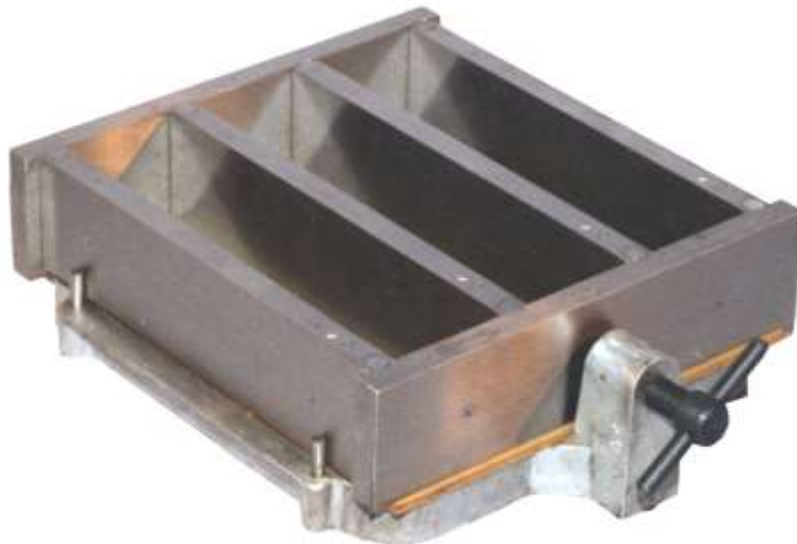
Рис. 14. Форма для виготовлення зразків-балочок
