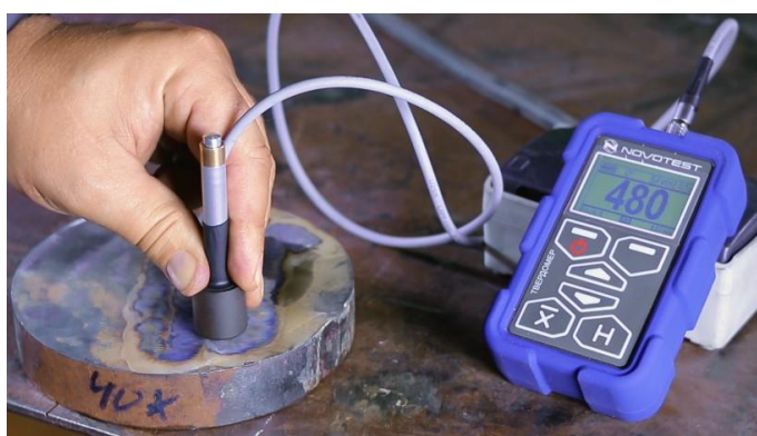
Рисунок 8.9 – Процес вимірювання твердості на поверхні зразка сталі 40X, яка піддавалась зміцненню
