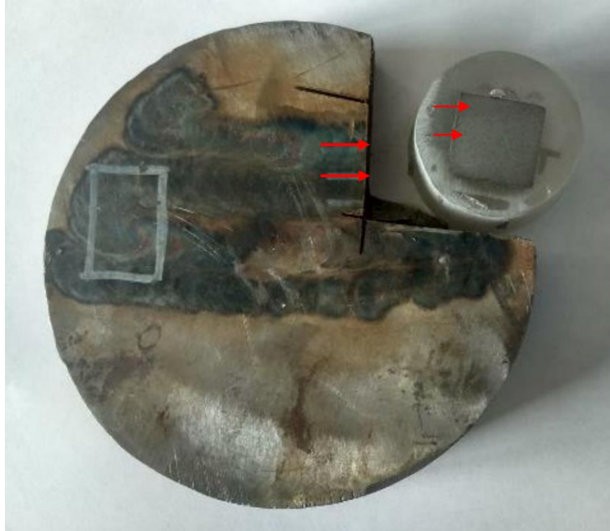
Рисунок 8.13 – Мікрошліф «зразка прокатної сталі» із зазначенням зони вирізки
