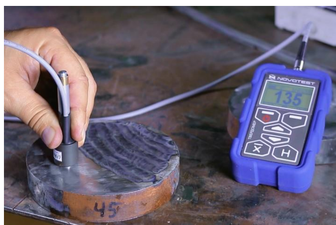
Рисунок 8.11 – Процес вимірювання твердості на поверхні зразка сталі 45, яка не піддавалась зміцненню
