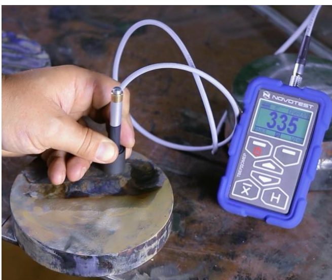
Рисунок 8.6 – Процес вимірювання твердості на поверхні зразка сталі 3, яка піддавалась зміцненню
