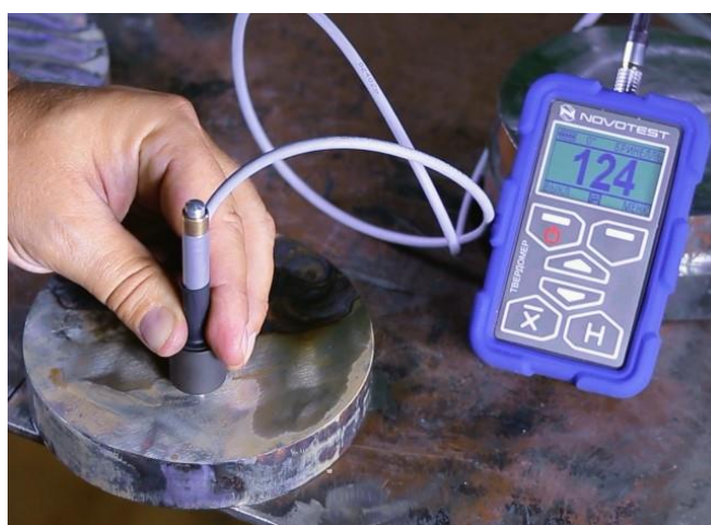
Рисунок 8.5 – Процес вимірювання твердості на поверхні зразка сталі 3, яка не піддавалась зміцненню
