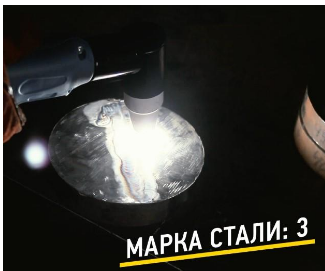
Рисунок 8.4 – Процес зміцнення зразка сталі 3
