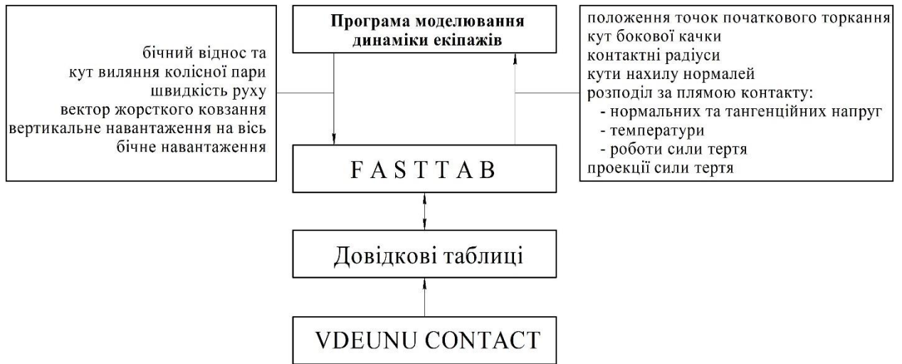
Рисунок 5.1 – Блок-схема створення та використання довідкових таблиць при моделюванні руху екіпажу
