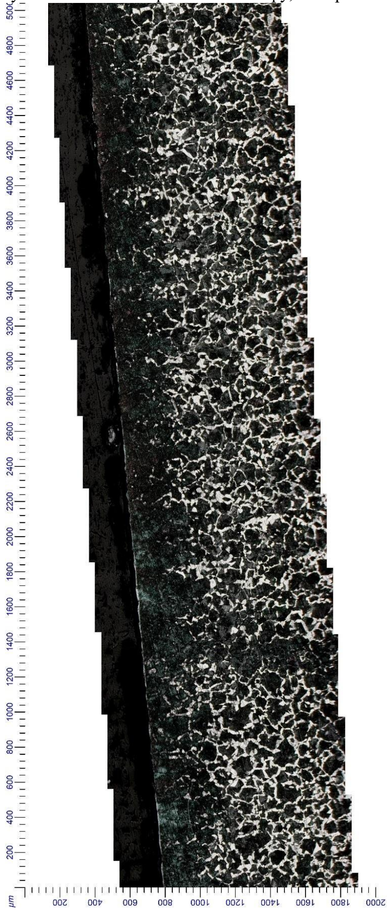
Рисунок 8.16 – Фото травленого шліфу, панорама x100
