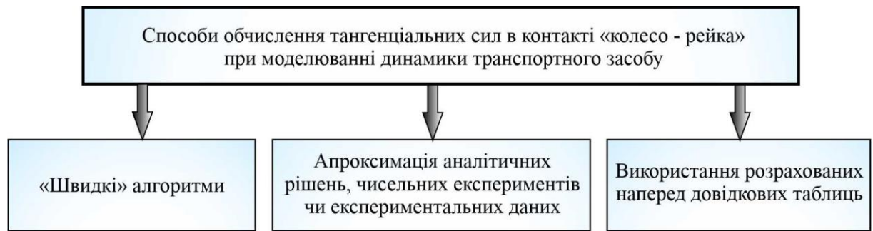
Рисунок 4.1 – Способи обчислення тангенціальних сил у контактi «колесо-рейка»
