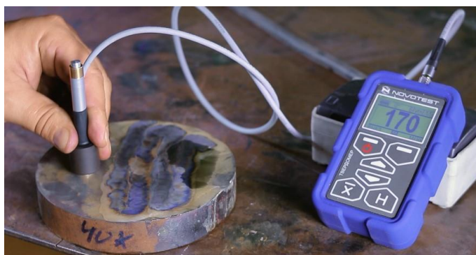
Рисунок 8.8 – Процес вимірювання твердості на поверхні зразка сталі 40X, яка не піддавалась зміцненню
