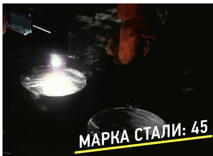
Рисунок 8.10 – Процес зміцнення зразка сталі 45
