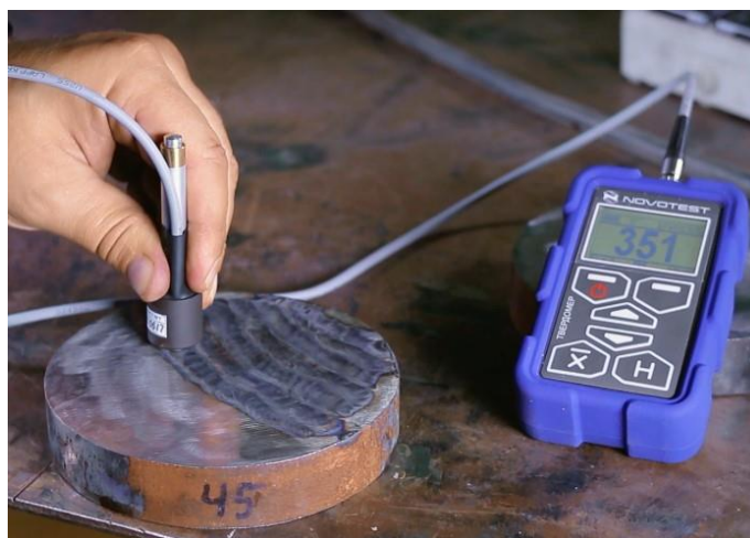
Рисунок 8.12 – Процес вимірювання твердості на поверхні зразка сталі 45, яка піддавалась зміцненню
