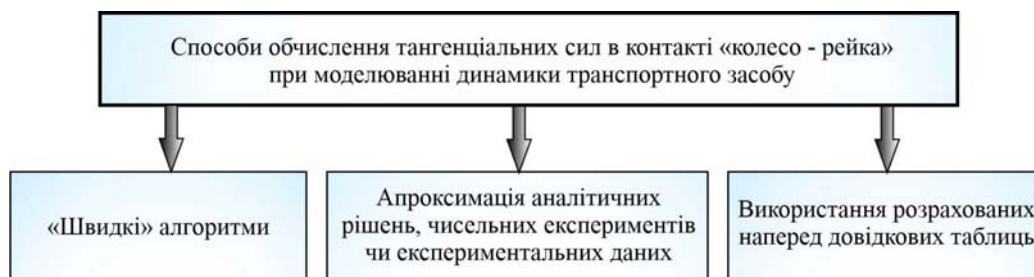
Рис. 1. Способи обчислення тангенціальних сил у контактї «колесо-рейка»
