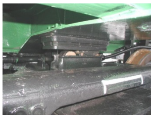
Рис. 2. Пружно-катковий ковзун фірми «А.Стакі»
