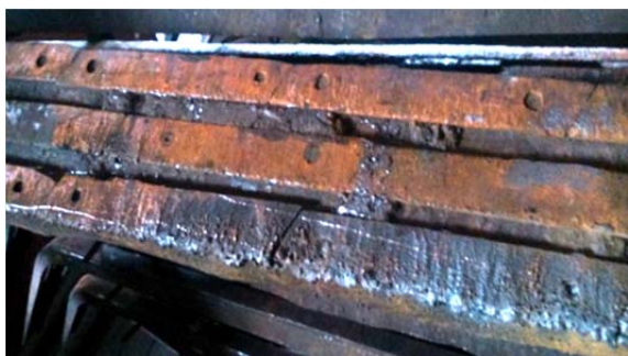
Рис. 5. Оплавлення контактних пластин
