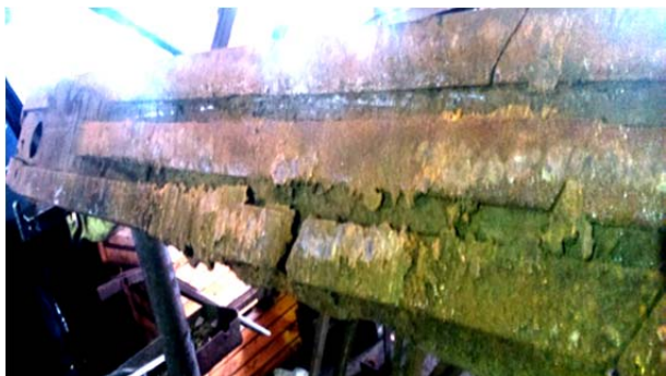
Рис. 4. Нагортання міді з контактного дроту на полози струмоприймача
