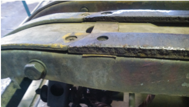
Рис. 8. Перекриття шунтуючими пластинами технологічних отворів на полозі
