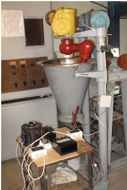
Рис. 7. Змішувач ПШ-24 (модернізований планетарно-шнековий змішувач фірми «Nauta» (Нідерланди))
