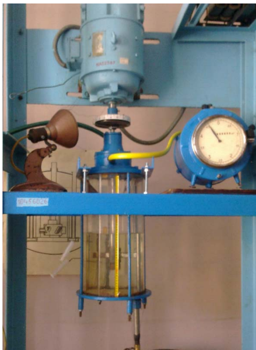
Рис. 2. Фото експериментального стенду для проведення випробувань самоусмоктувальних ежекційних мішалок
