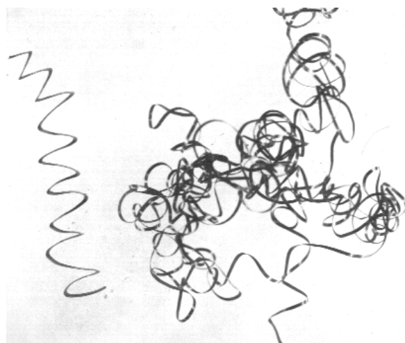
Рис. 5. Форма стружки при обробці сталі 30ХГСА прохідним різцем з твердого сплаву марки ВК6ОМ (при подачі S_0 = 0,05 мм/об – зливна стружка, при подачі S_0 = 0,2 мм/об – стружка надлому)
