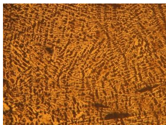
Рис. 1. Мікроструктура немодифікованого чавуна: (3,4 - 3,5 мас. % С; 10 - 11 мас. % Mn; 2,5 - 2,7 мас. % Al; 1,7 - 1,9 мас. % Si): структура – аустеніт + вторинний цементит + ледебурит; вміст вторинного цементиту та ледебуриту 45 - 50 %; \times 100
