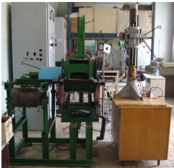
Рис. 1. Конструкція експериментальної установки: 1 – модельний апарат; 2 – рама; 3 – електродвигун; 4 – пасова передача; 5 – пружна муфта; 6 – віброплатформа; 7 – пружини; 8 – вібратор; 9 – стробоскоп; 10 – катетометр
