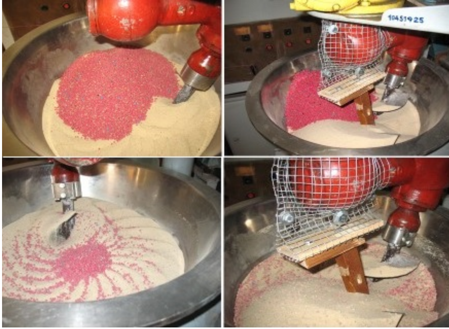
Рис. 5. Візуальне зрівняння розподілу компонентів (пісок та гранульований поліетилен) після 6 обертів водила без та з додатковим змішувальним елементом
