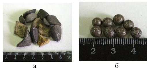
Рис. 12. Фото робочих тіл, що використовувалися при проведенні експериментальних досліджень: а – АН-2; б – сталеві загартовані поліровані кулі \varnothing 5 мм
