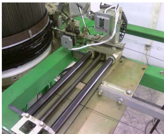
Рис. 5. Установка укладки горизонтальных стержней роликом (подающая каретка)
