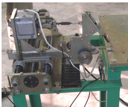
Рис. 4. Устройство раскладки стержней в кассету
