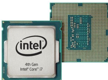
Рисунок 8.1 – Процесор четвертого покоління мікроархітектури Intel Core – Haswell
