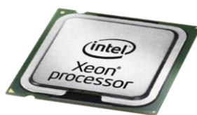
Рисунок 3.4 – Процесор Xeon – представник процесорів на базі ядра Beckton
