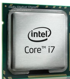
Рисунок 3.1 – Процесор Intel Core i7 мікроархітектури Nehalem
