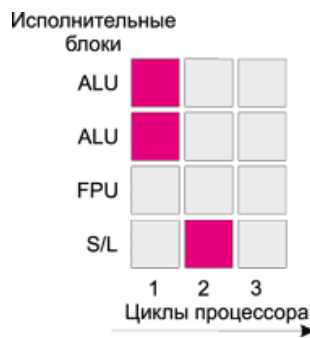
Рисунок 2.9 – Реалізація паралельного виконання інструкцій
