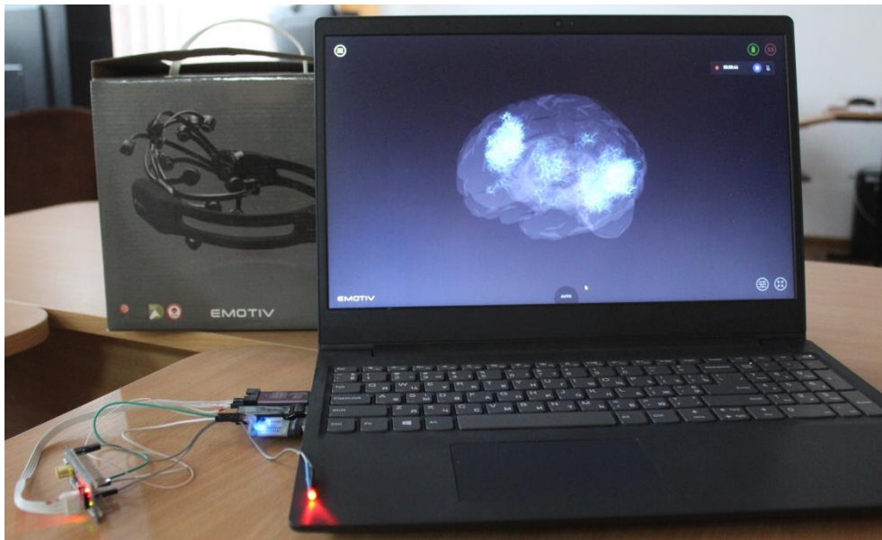
Рисунок 1 – Демонстрація нейрокомп'ютерного інтерфейсу для управління світлодіодом
