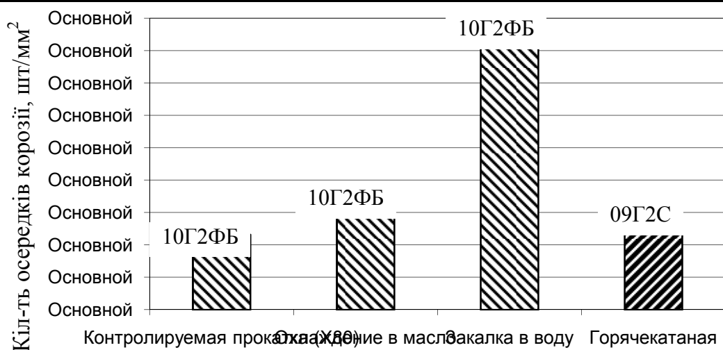
Рис. 3. Вплив характеру обробки сталей 09Г2С і 10Г2ФБ на кількість утворених осередків корозії на 11 добу атмосферної корозії
