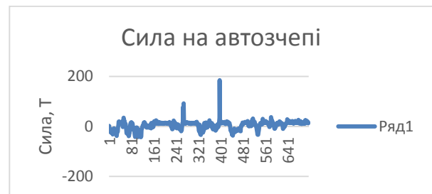
Рис. 9. Сила на автозчепному пристрої
