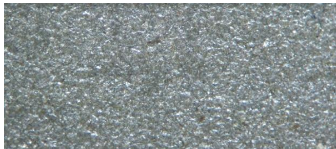
Рисунок 2.8 – Поверхня зразків після впливу двофазного потоку гранул сухого льоду, \times 50
