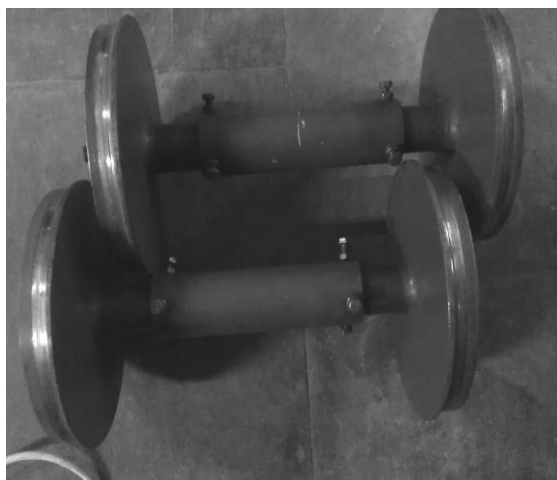
Колісна пара з колесами ТКС
