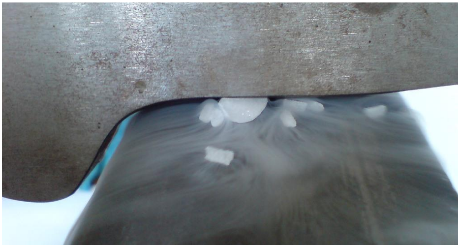
Рисунок 4.4 – Процес очищення гранулами сухого льоду
