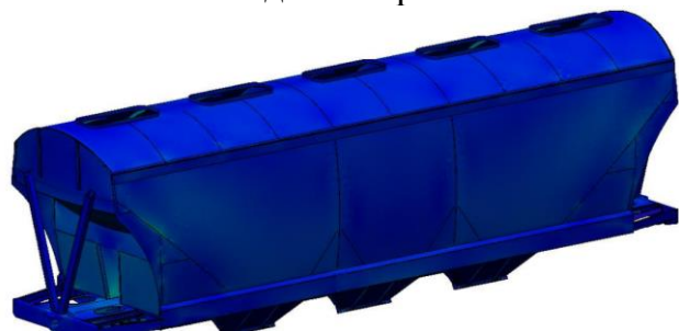
Рис. 1 Епюра напружень за I режимом (розтяг)
