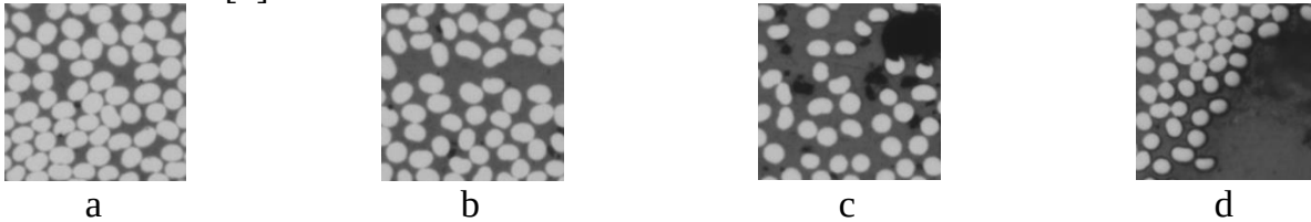
Рисунок 1. Типові приклади мікроструктури композитів: а) зона високоякісного композиту; б) зони, багаті матрицею; с) зона низької якості з пористістю; d) зони, багаті смолою, з пористістю.
