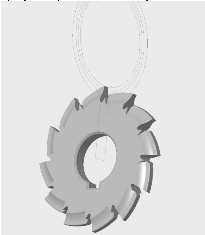
Рисунок. Параметрична тривимірна модель дискової зуборізної фрези
