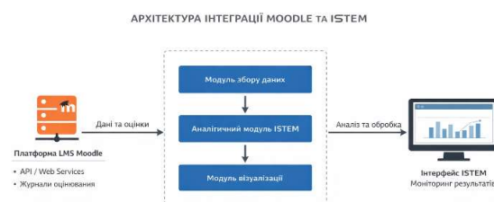
Рис. 3. Схема інтеграції LMS Moodle з аналітичним модулем ISTEM у структурі комп'ютерно-інтегрованої системи моніторингу
