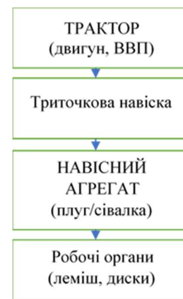
Рис. 1. Схема машинно-тракторного агрегату з навісним обладнанням
