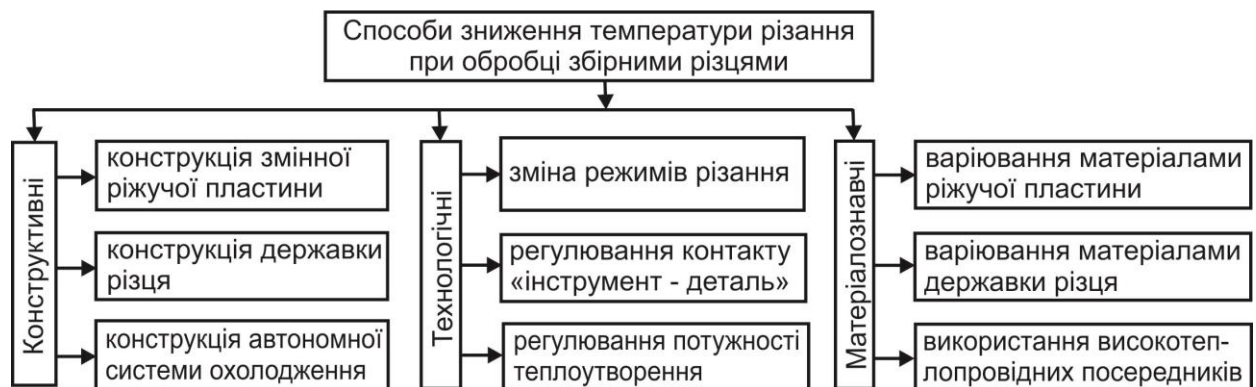
Рис. 2. Класифікація способів зниження температури різання при обробці збірними різцями
