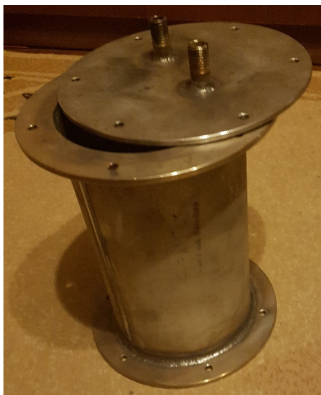
Рис. 1. Загальний вигляд корпусу колони виділення продукту реакції процесу каталітичної гідратації ацетилену
