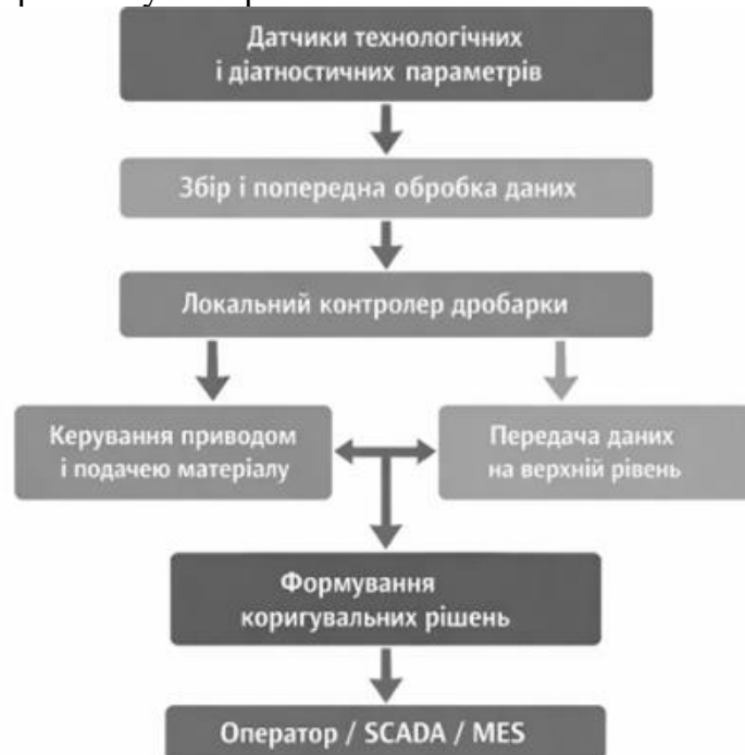
Рисунок – Узагальнена структура комп'ютерно-інтегрованої системи керування дробаркою
