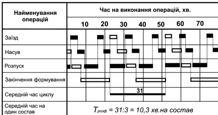
Рис. 6.10. Графік роботи механізованої гірки з двома коліями насуву при двох гіркових локомотивах
