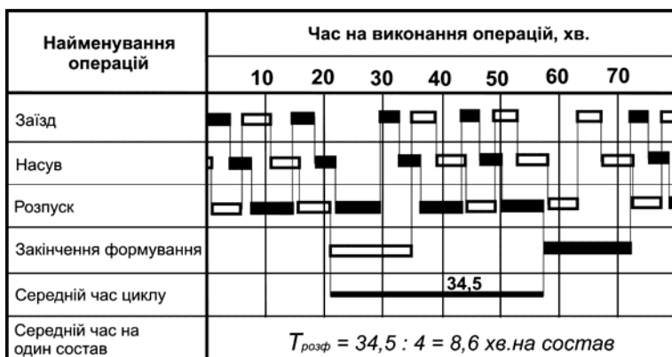
Рис. 6.11. Графік роботи механізованої гірки з двома коліями насуву при автоматизації процесу сортування вагонів
