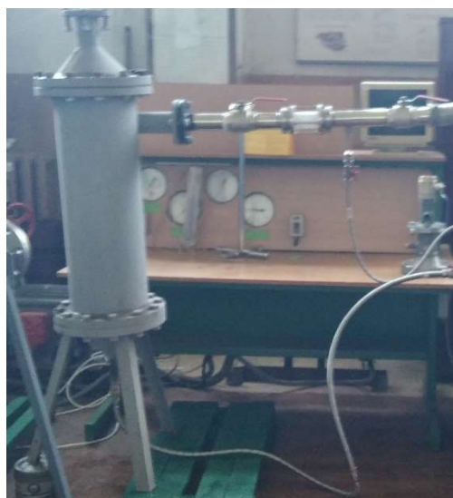
Рис. 2. Лабораторно-експериментальний газорідний сепаратор
