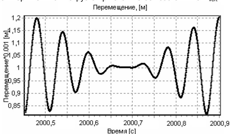
Рис. 8. Временная зависимость величины перемещения [S] в точке, удаленной от внешнего радиуса на 3 см, V=198 км/ч, без учета динамической нагрузки и направляющего усилия Y
