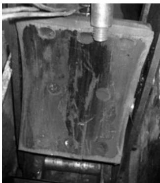
Рис. 5. Гальмівна колодка після випробувань
