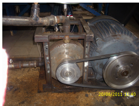
Рис. 3. Кавитационный насос-теплогенератор (используется для ускорения химических реакций)
