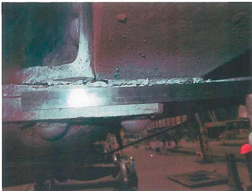
Рис. 6. Тріщина в зварному шві який з'єднує хребтову балку з шворневою
