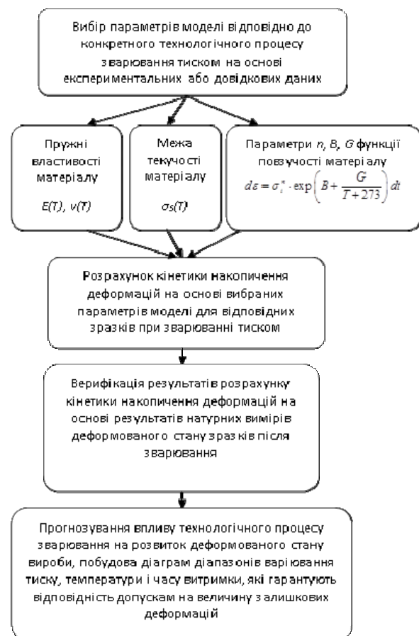
Рис. 2. Схема методики розрахунку параметрів процесу прецизійного зварювання тиском.
