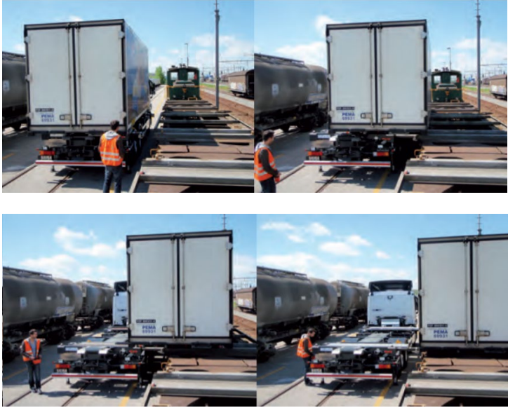
Рис. 1. Принцип дії системи ContainerMover
