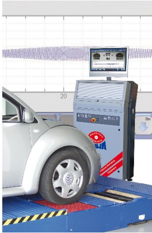
Рис. 1. Стенд перевірки амортизаторів MSD 3000 EURO МАНА
