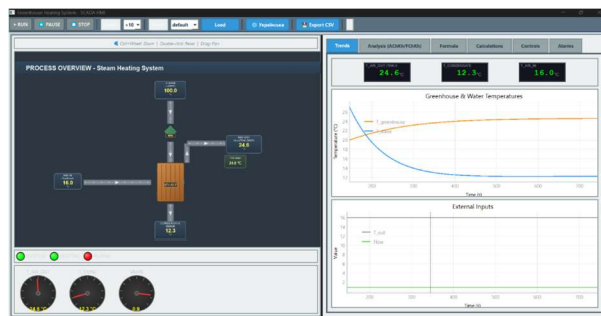
Рис. 3. Візуалізація цифрового експериментального середовища: мнемосхема теплового контуру та тренди температур (SCADA/HMI)
