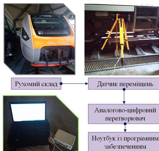
Рис. 2. Схема та інформаційно-вимірювальне забезпечення для проведення записів деформування пневматичної ресори рухомого складу
