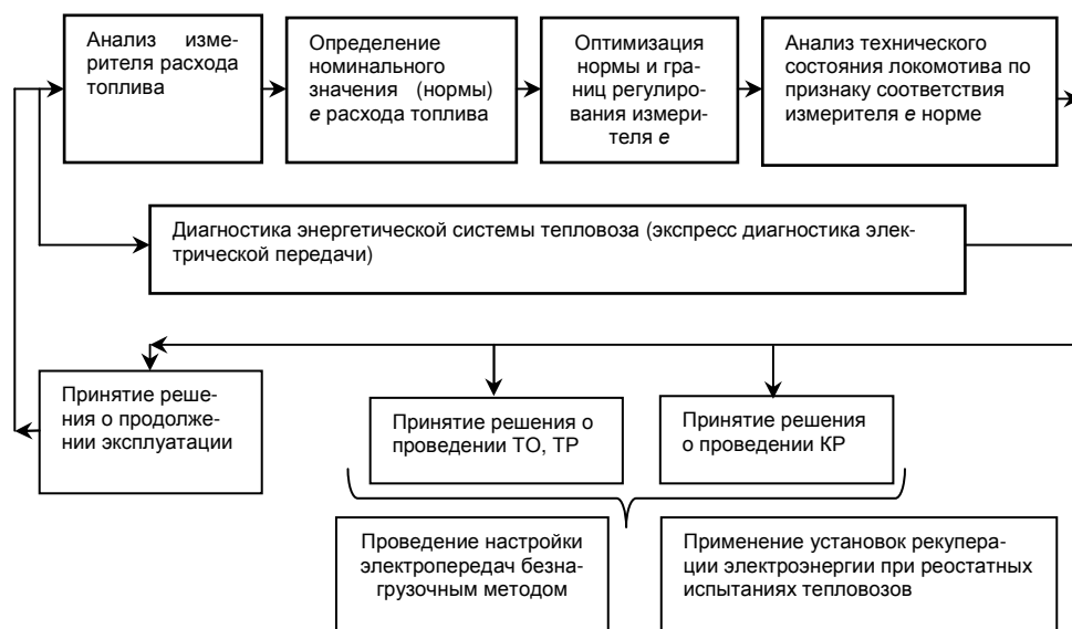
Рис. 1. Структурная схема основных этапов контроля энергетических установок тепловозов
