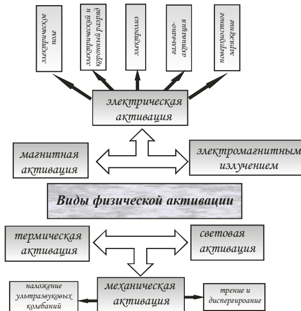
Рис.2. Классификация основных видов активации смазок
