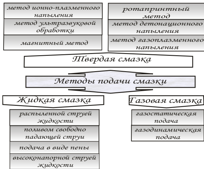
Рис. 1 Классификация методов подачи смазки в трибосопряжении
