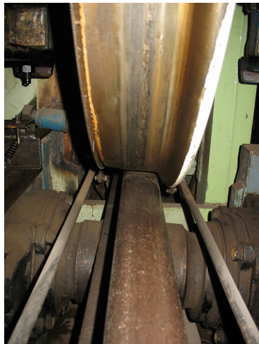
Рис. 4. Внешний вид системы взаимодействия «колесо-рельс» ИИК
