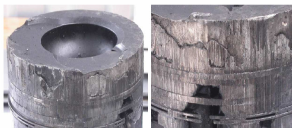
Рис. 3. Результаты срыва масляной пленки вследствие желирования моторного масла
