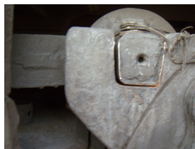
Рис. 3. Деформация верхнего поводка
