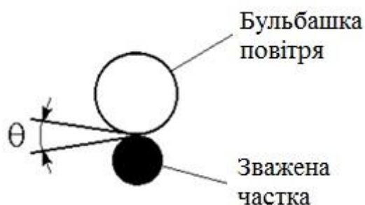
Рис. 4.2. Схема прилипання бульбашки повітря до зваженої частинки
