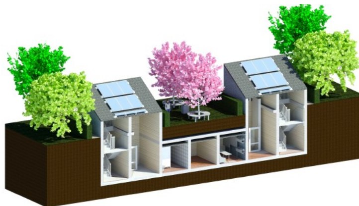
Рисунок 1. Пропозиція влаштування підземного укриття
