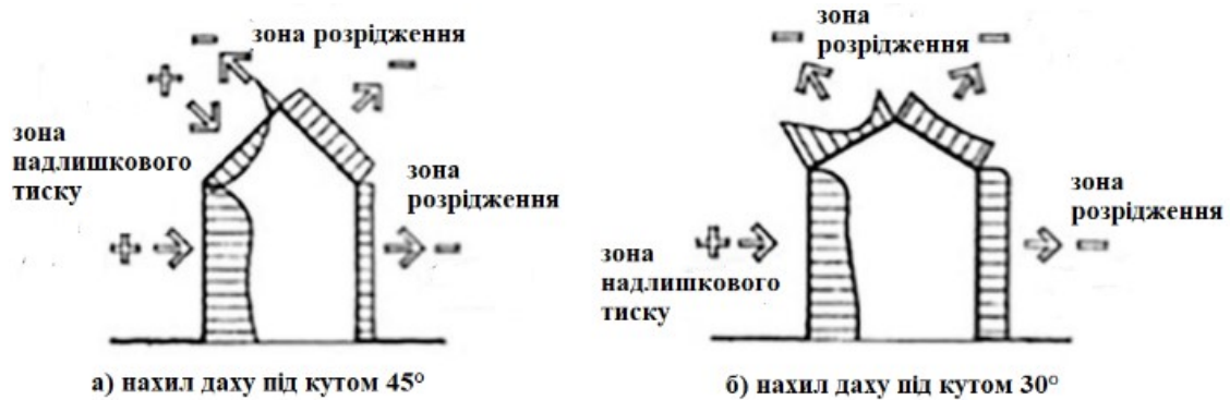
Рисунок 2. Нахил даху та тиск повітря
