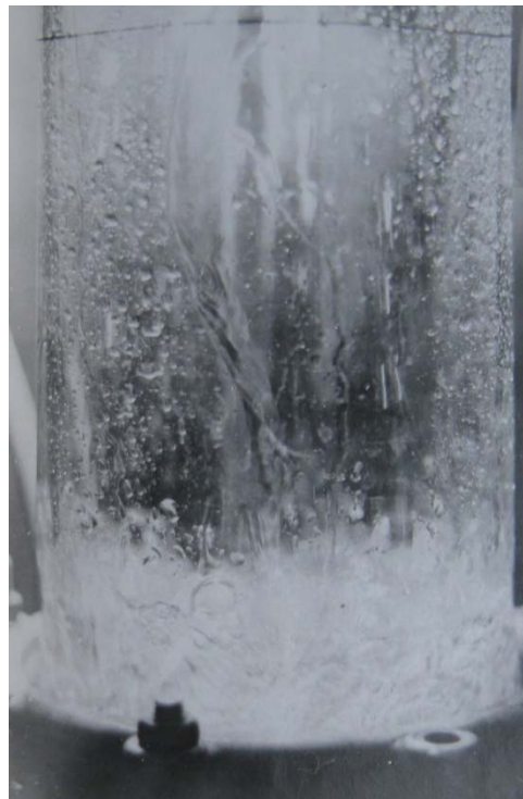
Рис. 1. Робота тарілки провального типу у режимі однорідного барботажного шару: L = 12,7 \text{ м}^3/(\text{м}^2 \cdot \text{ч}) , w = 0,72 \text{ м/с} .
