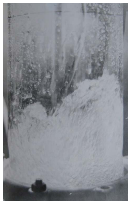
Рис. 2. Робота тарілки провального типу в режимі рухомому газорідинного шару: L = 12,7 \text{ м}^3/(\text{м}^2 \cdot \text{ч}) , w = 0,83 \text{ м/с} .
