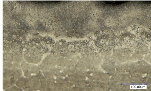
Рис. 3. Мікроструктура сталі P18 після обробки при щільності потужності лазерного випромінювання q = 1,4 \cdot 10^4 Вт/см 2 (швидкість переміщення лазерного променя V = 10 мм/с): оплавлена зона (зона гартування з рідкого стану; тонка перехідна зона з підвищеною мікротвердістю (зона гартування з твердого стану); основний метал; х600
