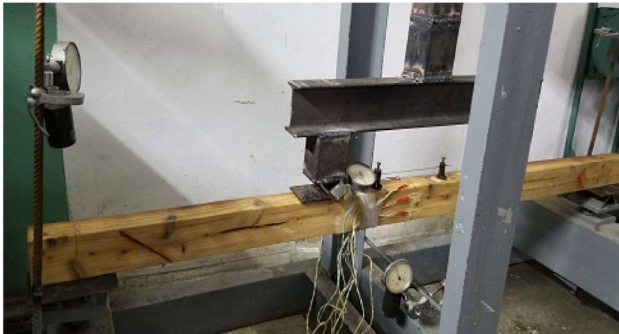
Рис.1. Випробування балки з деревини ялини після впливу вологи (прісної води)
