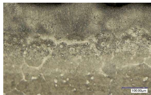
Рис. 3. Мікроструктура поверхневого шару сталі Р18 після електронно-променевої обробки з оплавленням: q = 1,35 \cdot 10^4 Вт/см 2 ( V = 11 мм/с); \times 600
