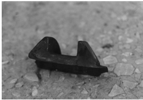
Рис. 3. Картина износа вспомогательной поверхности трения
