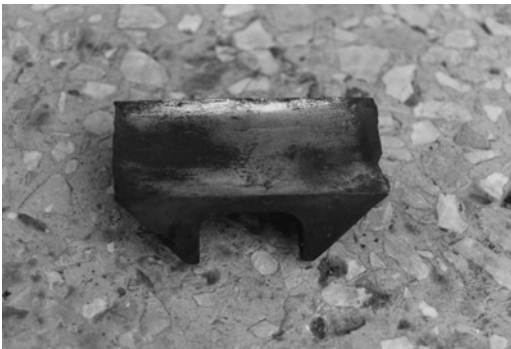
Рис. 2. Картина износа главной поверхности трения
