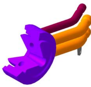
Рис. 4. Сборка узла межэлектродной вставки плазмотрона в системе КОМПАС-3D
