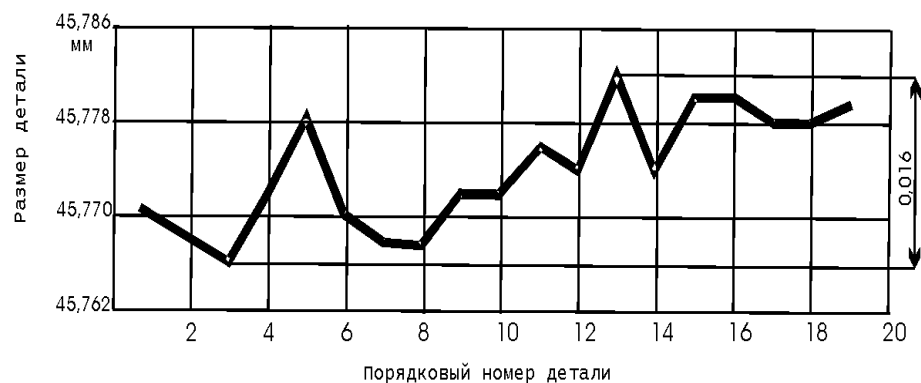
Рис. 1. Рассеяние размеров при шлифовании
