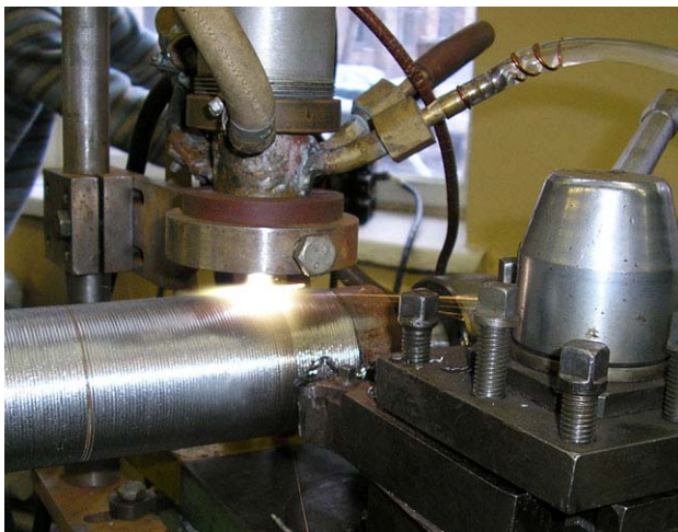
Рис. 6. Расположение плазматрона на токарном станке при плазменно-механическом точении заготовки
