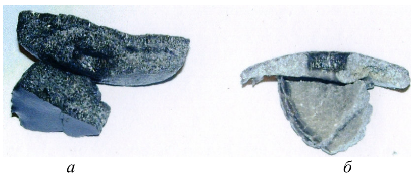
Рис. 3. Внешний вид расплава NaCl до процесса окисления (а) и после него (б).
