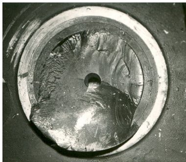
Рис.1. Общий вид усталостного разрушения вала компрессора (вид со стороны щеки)
