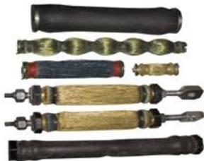
Рис. 2. Повітряний м'яз Air Muscle компанії Shadow Robot Company.
