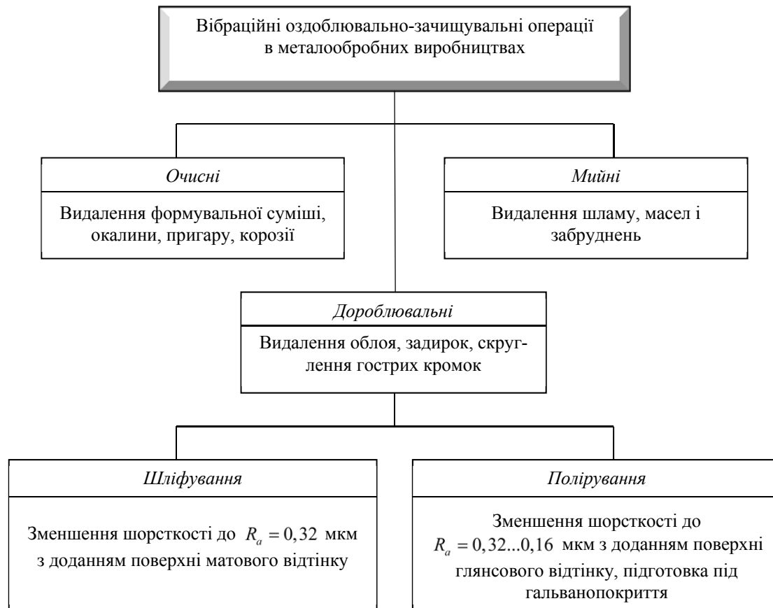
Рис. 1. Класифікація вібраційних оздоблювально-зачищувальних операцій, що застосовуються в металообробних виробництвах
