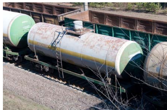
Рис. 5. Вагон-цистерна 15-1408 для аміаку
