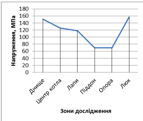
Рис. 7. Графік напружень в контрольних точках
