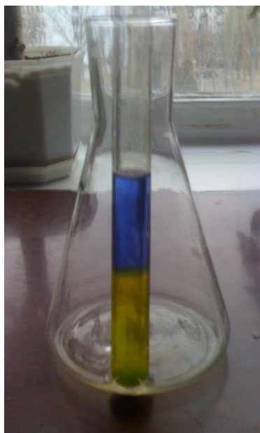
Рис. 2. Результат фармакопейної реакції виявлення перекису водню в розчині. Синє забарвлення у верхньому шарі – сольват пероксиду оксиду хрому (VI) з диетиловим етером.
