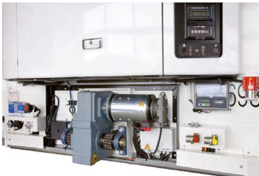
Рис. 2. Привід системи, встановлений під рефрижераторною установкою
