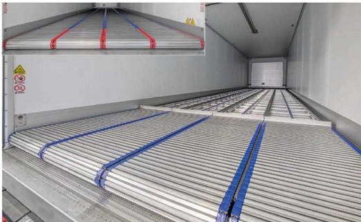
Рис. 1. Система CargoMatic із використанням пластинчастого конвеєра з ланцюговим приводом
